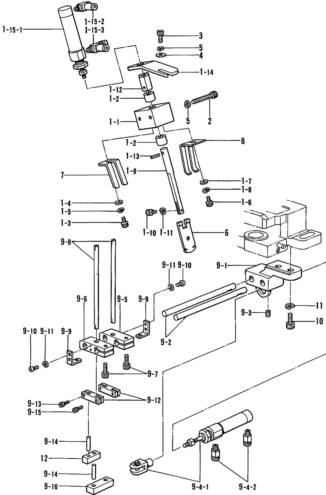
M. 糸切り関係/Thread trimmer mechanism/Fadenabschneidevorrichtung/
