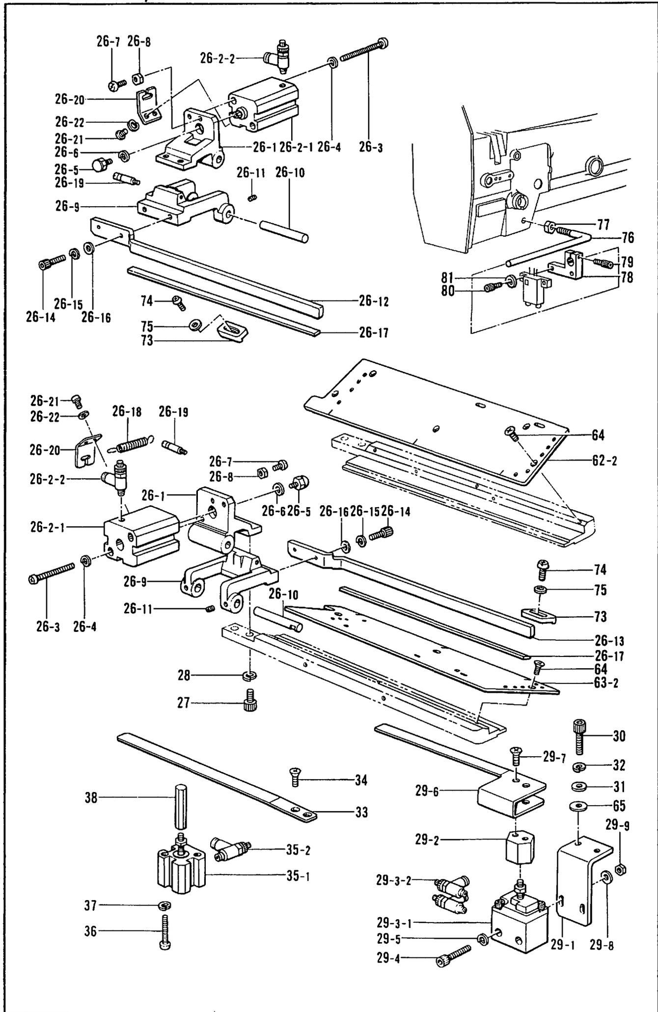
R4. 布制御関係/Cloth control system mechanism/StoffführungsVorrichtung/
