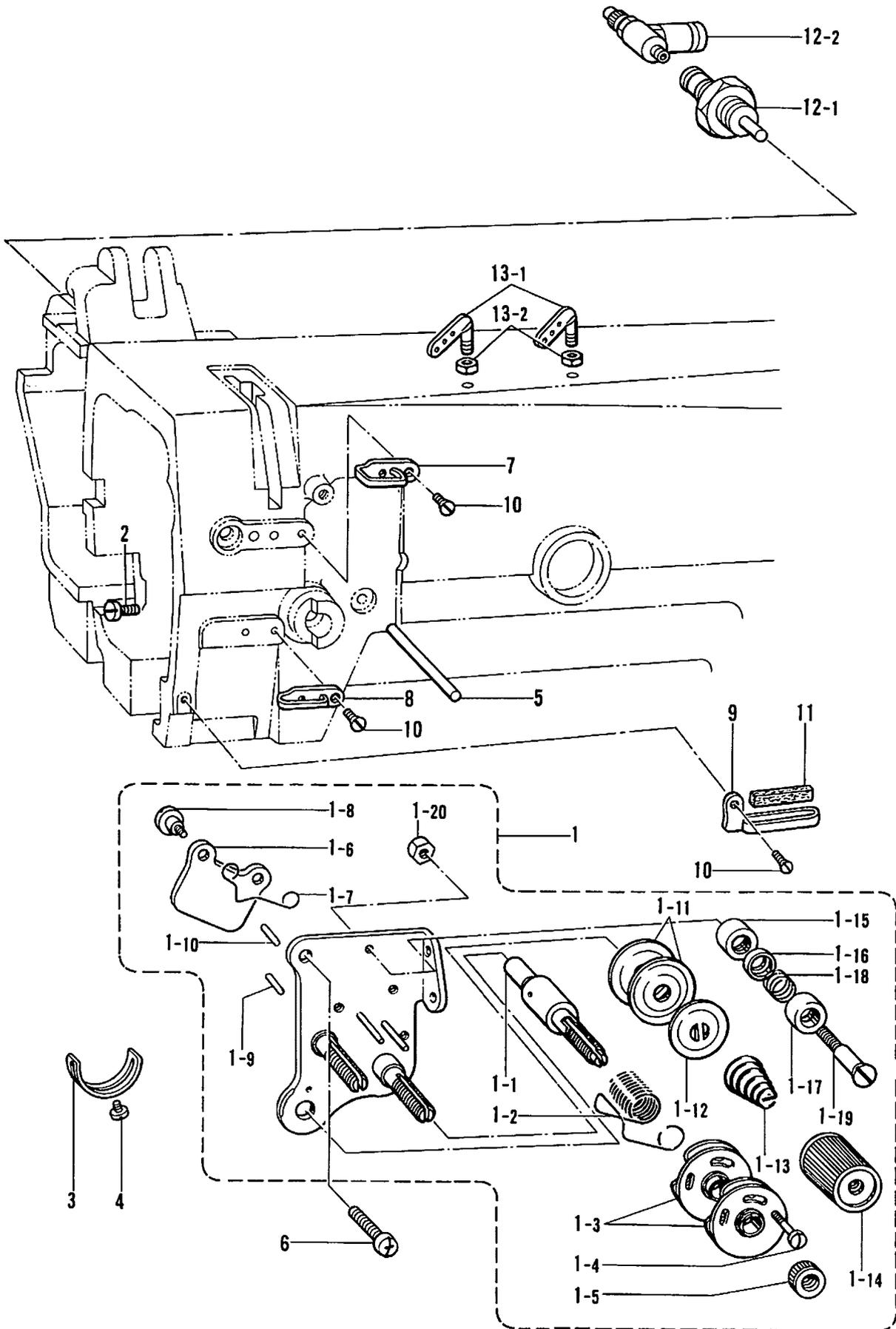
H. 糸通シ関係/Threading mechanism/FadenführungsVorrichtung/
