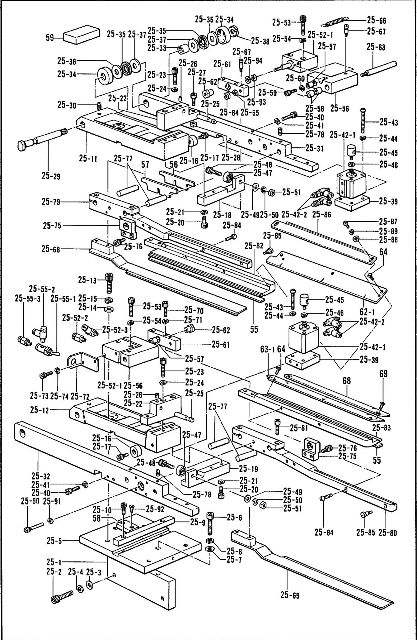
R3. 布制御関係/Cloth control system mechanism/StoffführungsVorrichtung/
