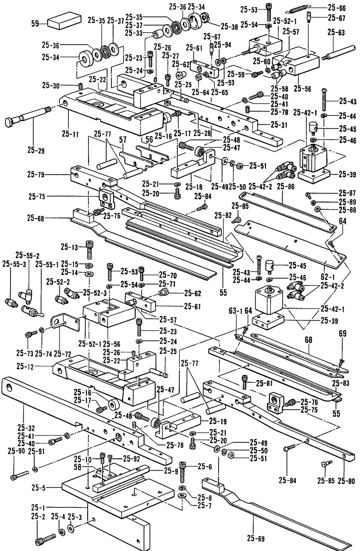
R3. 布制御関係/Cloth control system mechanism/StoffführungsVorrichtung/
