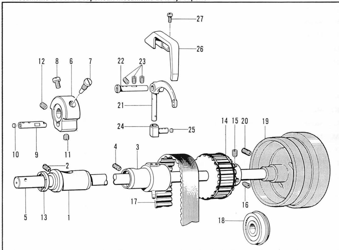
A. 主体関係/Machine body/Maschinengehäuse/
