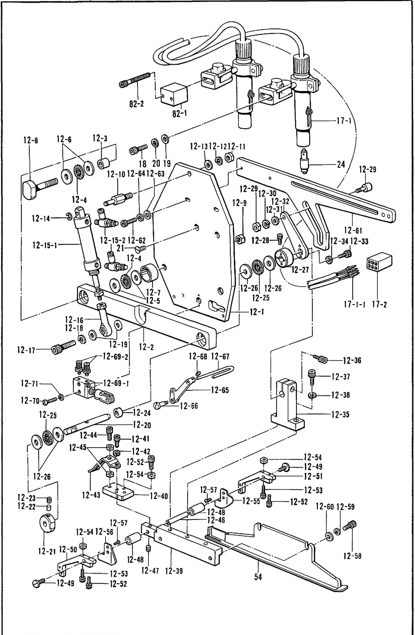
R2. 布制御関係/Cloth control system mechanism/Stoffführungsvorrichtung/
