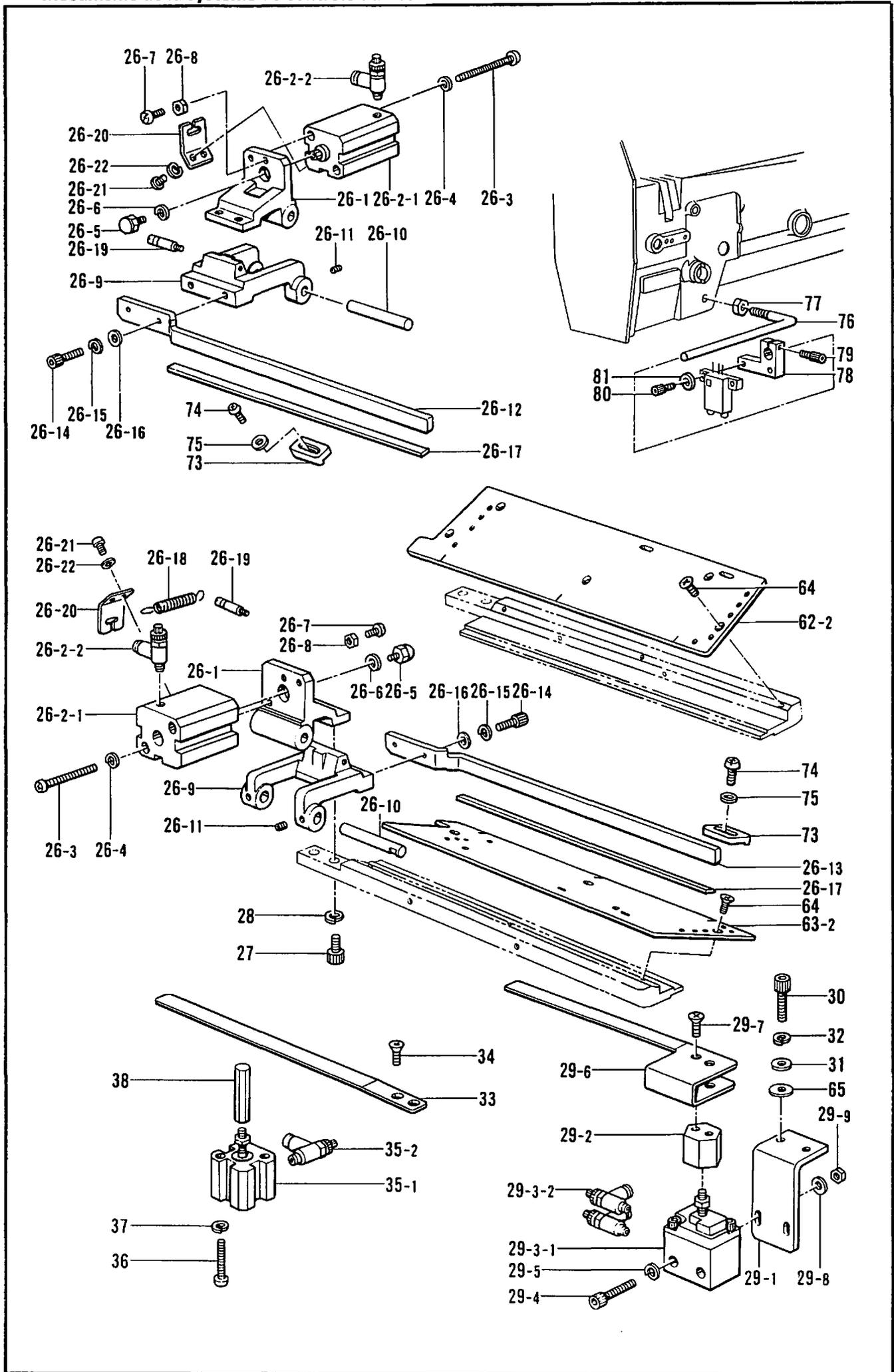
R4. 布制御関係/Cloth control system mechanism/Stoffführungsvorrichtung/
