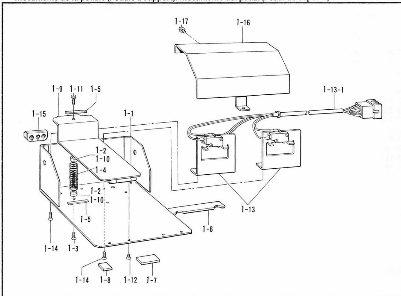
Z1. 付属品関係 (自動機付属) / Accessories (provided with automatic sewing machine) / Zubehör (mit automatischer Nähmaschine) / Accessoires (avec la machine à coudre automatique) / Accesorios (que vienen con la máquina de coser automática)
