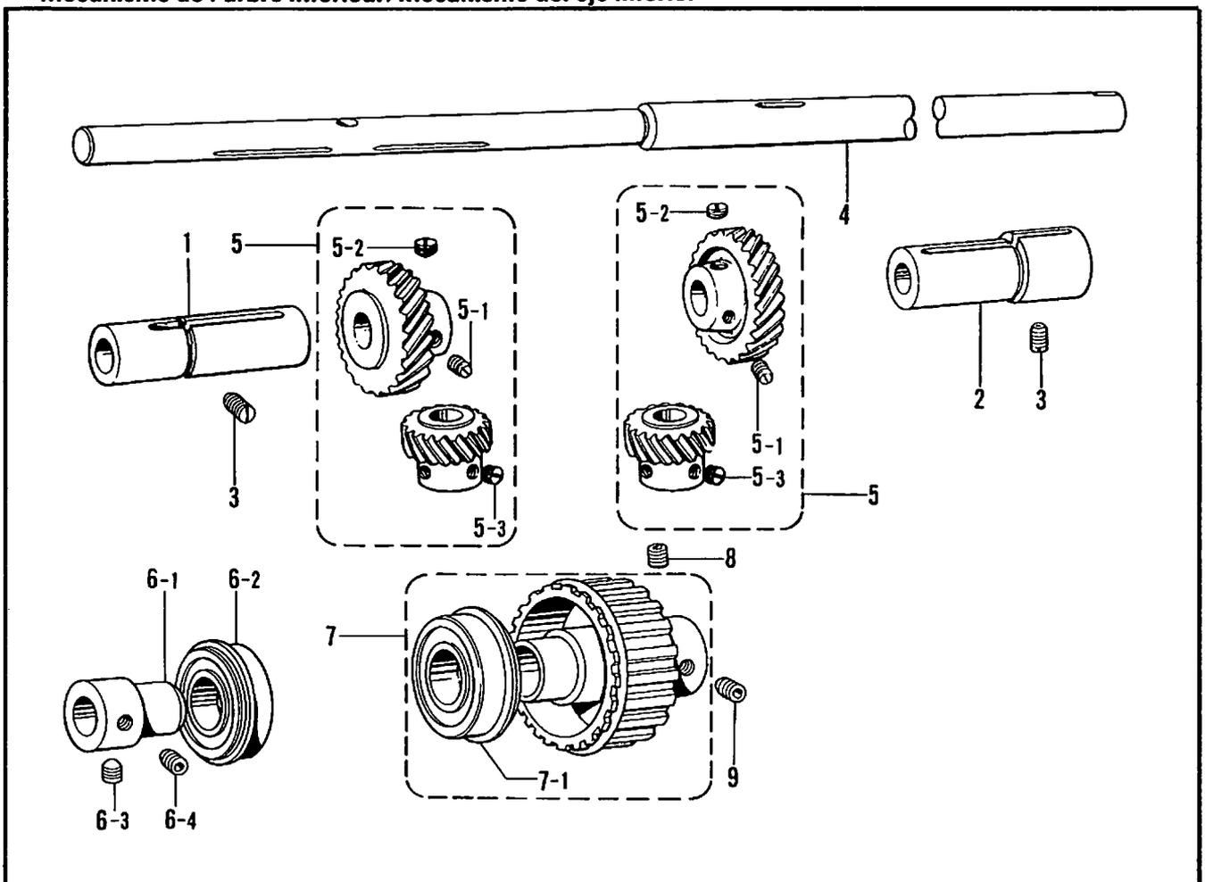
C. 針棒揺動関係/Needle bar rocking mechanism/Nadelstangenbetätigung/
